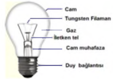
Ampulün Yapısı
