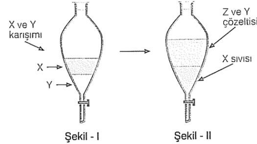
Yukarıda Şekil - I deki ayırma hunisinde X - Y karışımı bulunmaktadır. Kaba Z sıvısı eklendiğinde Şekil - II deki gibi durum oluşuyor.
