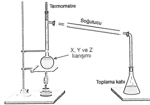
Şekildeki basit damıtma düzeneğinde X, Y ve Z sıvılarının karışımı ayrılmaktadır.
