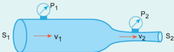
Düşey kesiti şekildeki gibi olan kaptan su pompalanmaktadır. Akan suyun  $S_1$  kesisindeki hızı  $v_1$ , basıncı  $P_1$ ;  $S_2$  kesisindeki hızı  $v_2$ , basıncı da  $P_2$  dir.
