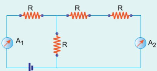
Özdeş dirençlerle kurulan şekildeki elektrik devresinde  $A_1$  ampermertesinden  $i_1$ ,  $A_2$  den de  $i_2$  akımı geçiyor.
