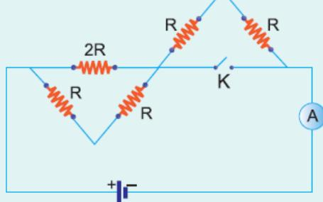
Şekildeki devrede K anahtarı açık iken A ampermertesinden geçen akım şiddeti i dir.
