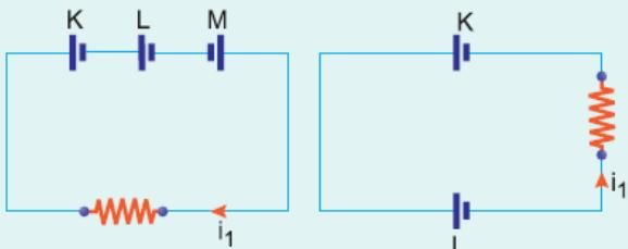
K, L, M üreteçleri ile kurulan devrelerde dolaşan  $i_1$  ve  $i_2$  akımlarının yönleri şekildeki gibidir.
