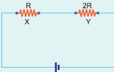
$R$  ve  $2R$  büyüklüklerindeki  $X$  ve  $Y$  dirençleri ile kurulmuş şekildeki devrede,  $X$  direncinden  $t$  sürede açığa çıkan ısı enerjisi  $Q$  dur.
