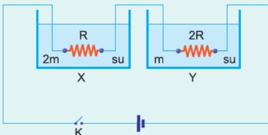
$R$ ,  $2R$  büyüklüklerindeki dirençlerle kurulmuş şekildeki düzenekte,  $K$  anahtarı açık iken  $X$  ve  $Y$  kaplarında bulunan  $2m$ ,  $m$  kütleli suların sıcaklıklarını birbirine eşit ve  $T$  dir.  $K$  anahtarı kapatıldıkten bir süre sonra  $X$  kabındaki suyun sıcaklığı  $2T$  oluyor.
