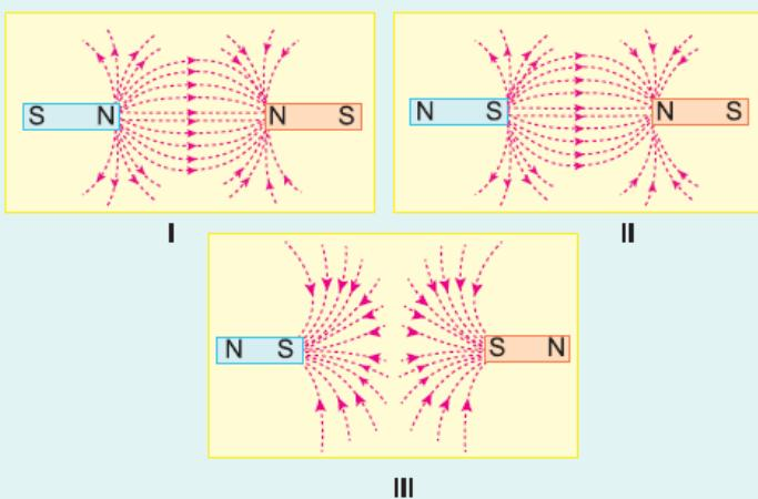
Özdeş mıknatıslar arasında oluşan kuvvet çizgilerinin biçimini ve yönü şekildeki I, II, III düzeneklerinde çizilmiştir.
