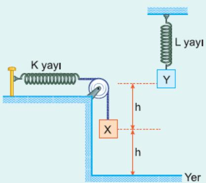
Şekildeki düzenekte özdeş K, L yaylarına, X, Y cisimleri asılıdır. Cisimlerinin yere göre potansiyel enerjileri birbirine eşittir.
