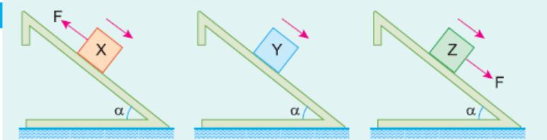
Şekildeki sürtünmesiz eğik düzlemede, verilen oklar yönünde hareket eden özdeş X, Y, Z cisimlerinin ivmelerinin büyüklükleri sırasıyla  $a_X$ ,  $a_Y$ ,  $a_Z$  dir.
