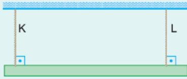
Ağırlığı  $P$  olan bir çubuk K ve L ipleriyle şekildeki gibi asılmıştır. Bu durumda K ipindeki gerilme kuvveti  $T_K$ , L deki de  $T_L$  dir.
