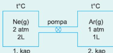
Sabit sıcaklığında, pompa yardımıyla 1. kaptaki ideal Ne gazının yarısı 2. kaba aktarılıyor.
