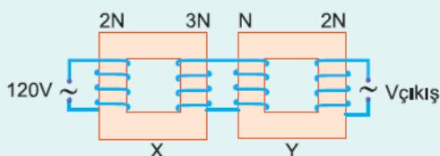
Şekildeki gibi bağlanmış ideal X ve Y transformatörlerine 120 V luk alternatif gerilim uygulanmıştır.
