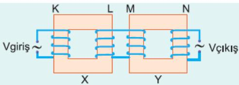
K, L, M, N bobinlerinden oluşan ideal X ve Y transformatörleri şekildeki gibi bağlanmıştır.
