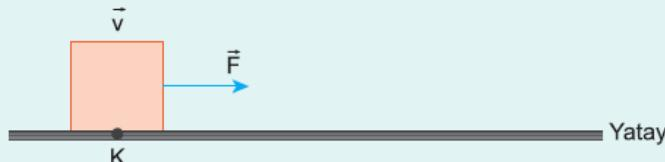
Bir cisim, şekildeki sürtünmeli yatay düzlemede yola paralel olarak uygulanan  $\vec{F}$  kuvvetinin etkisinde hareket ediyor.
