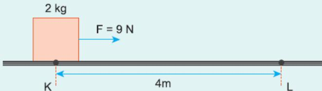
Sürtünmesiz yatay düzlemede duran 2 kg kütleli cisim,  $F = 9 \text{ N}$  büyüğündeki yatay kuvvet L noktasına kadar uygulanıyor.
